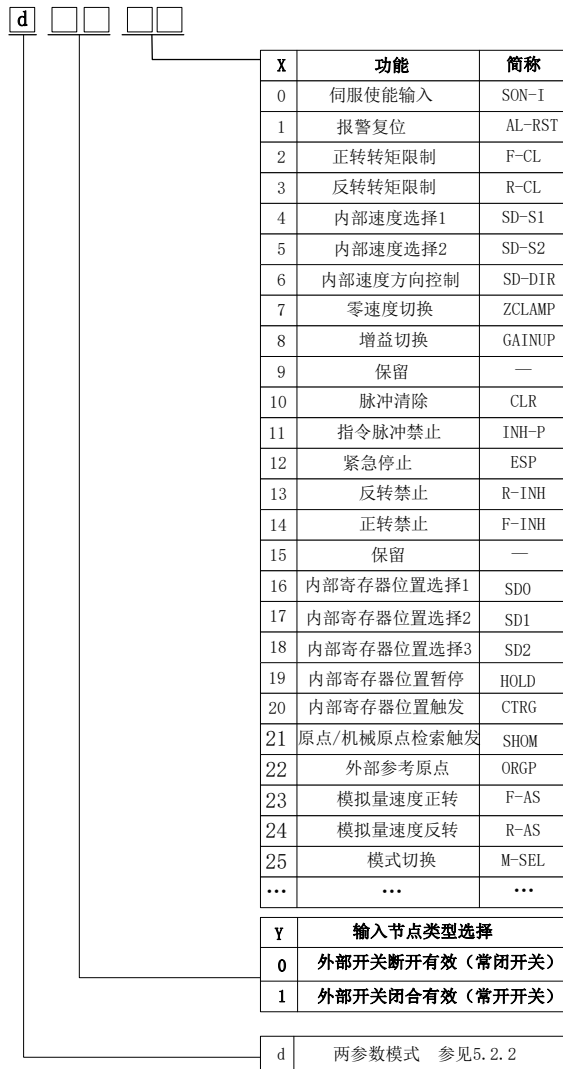
图 8.1.1 可编程输入端子功能设定示意图
