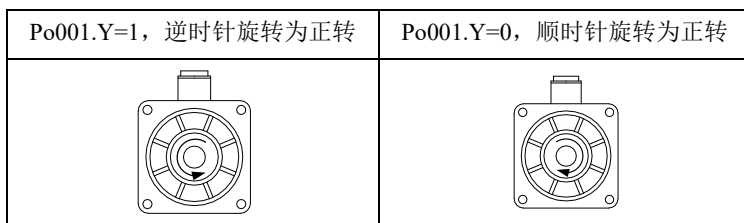
图 6.1.6 电机旋转方向示意图
