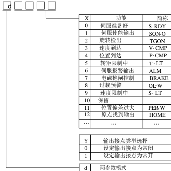
图 8.1.2 可编程输出端子功能设定示意图
